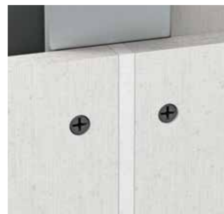
Tmelená spára fermacell – šířka spáry: \frac{1}{2} \times tloušťka desky + max. 3 mm
