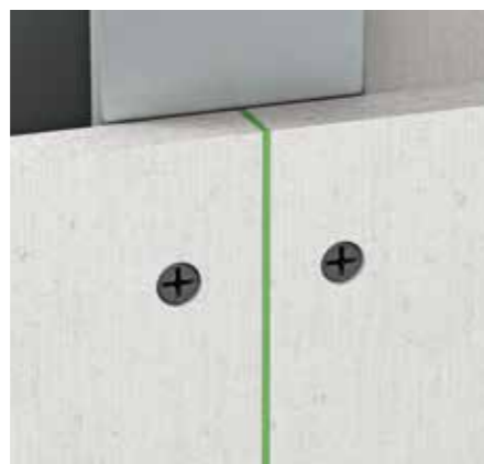
Lepená spára fermacell – šířka spáry: \leq 1 mm
