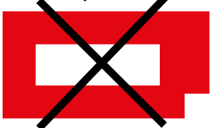
FRÉZOVANÁ VYBRÁNÍ V DESCE FUNDERMAX COMPACT
