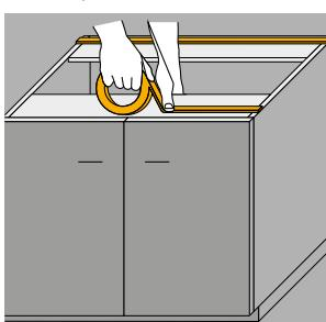
V místě budoucího lepeného spoje nejprve instalujte oboustranně lepící montážní pásku Sika Fixing Tape, na které ponechejte krycí folii. Páska vymezuje minimální tloušťku lepeného spoje 3 mm. V této chvíli je možno přiložit kompaktní pracovní desku pro kontrolu rovinnosti a osazení případných dorazových podložek.
