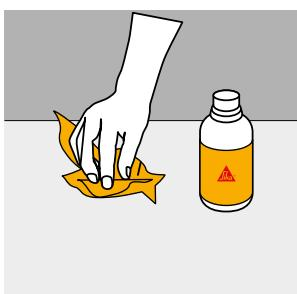
Následně provedte nanesení přípravku Sika Aktivator 205 v místě lepeného spoje v šíři cca. 50 mm pomocí namočeného papírového ubrousku, hadíku, případně pomocí štětce. Aplikaci provedte 3x vždy jedním směrem. Poté následuje technologická přestávka v délce
