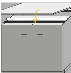
Po nanesení tmelu odstraňte krycí folii z oboustranné pásky, desku opřete na jedné straně o dorazové podložky a přiklopěte se na připravený podklad korpušu tak, aby došlo k úplnému kontaktu s montažní páskou. Lepící tmel se přitom dotvaruje a smočí obě lepené plochy.
