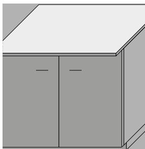
Po dobu vytvrzení tmele je kompaktní pracovní deska fixována v požadované poloze oboustranně lepící montážní páskou. POZOR: po přitlačení na oboustrannou pásku již není možná žádná korekce kompaktní pracovní desky. Po uplynutí cca. 8-24 hodin dochází k vytvrzení lepícího tmele pomocí vlhkosti obsažené ve vzduchu. Lepený spoj po vytvrzení zůstává trvale elastický – pružný.
