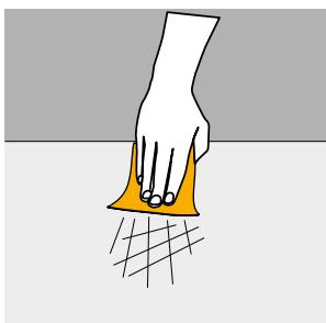
Kvalitní a trvalý lepený spoj začíná u čistých a dobře připravených podkladů. Ujistěte se, že oblast, která má být lepena je bez prachu, mastnot a nečistot. Povrch kompaktní pracovní desky a korpusu v místě lepení zdrsněte v šíři cca 50 mm pomocí minerální drátěnky. Po zdrsnění
