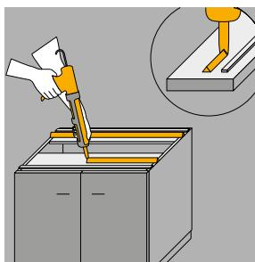
Po provedení případné kontroly naneste lepící tmel Sikaflex 552 rovnoběžně s páskou ve vzdálosti cca 10 mm od pásky tak, aby nedošlo po instalaci a přitlačení kompaktní pracovní desky k vniknutí tmele mezi pásku a desku. Tmel naneste vytlačovací pistolí na 300 ml kartuše pomocí speciálně upravené špičky s trojúhelníkovým výřezem 10 x 8 mm.
